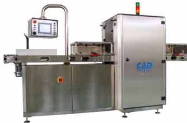
Porzionatrice a spicchi per formaggi tondi e quadri Pecorini, Asiago, Fior del Monte, Montasio...
