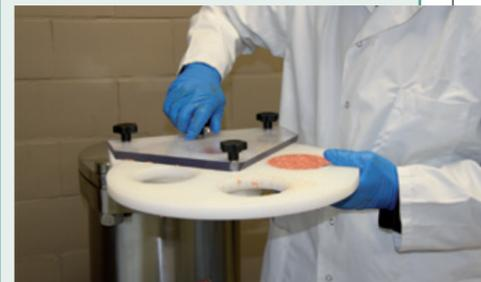
Molto semplice da usare e si può agganciare a qualsiasi tipo di insaccatrice. Questa macchina, in plastica alimentare e acciaio inox, si caratterizza per dimensioni estremamente compatte (350x377x114mm) e può essere usata per la produzione di hamburger di forme diverse. Si tratta di un attrezzatura molto economica, ideale per le produzioni saltuarie.
