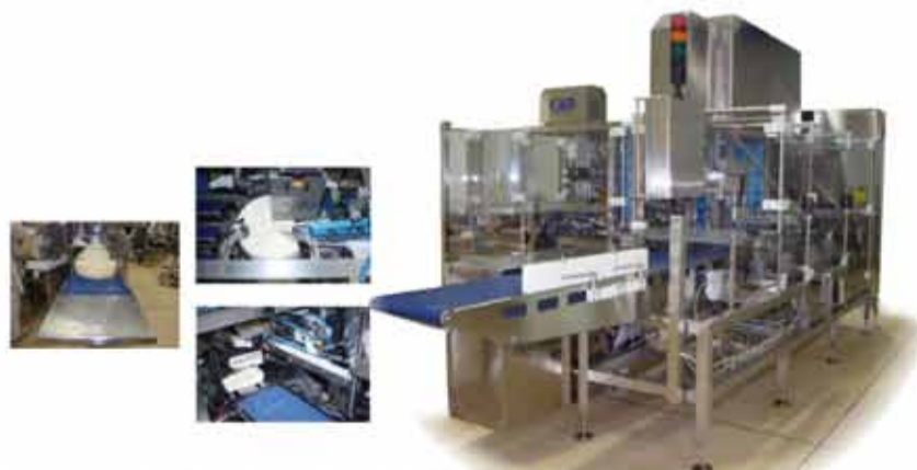
Linea automatica di porzionatura a peso fisso, taglio a ultrasuoni e inserimento in vaschetta per Gorgonzola e formaggi simili
