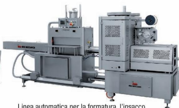
Linea automatica per la formatura, l'insacco e la clippatura PIC99B
