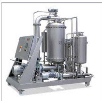
Della Toffola propone i filtri tangenziali a membrane ceramiche modelli Cfkn, Cfki, Cfka e Omnia che fanno uso di fibre cave minerali o inorganiche. L'utilizzo di materiale pregiato offre diverse garanzie: lunga durata di funzionamento (oltre 15 anni), compatibilità chimica, resistenza alle alte temperature, alla pressione e, di conseguenza, tolleranza agli agenti impiegati per il lavaggio e la sanificazione. Le membrane di tipo minerale/ceramico garantiscono la possibilità
