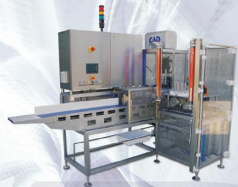
Impianto automatico di porzionatura a peso fisso, con taglio a lama ultrasuoni
