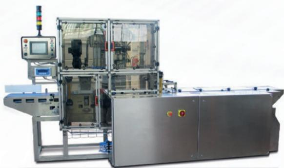
Impianto automatico di porzionatura a peso fisso e taglio a lama ultrasuoni.
