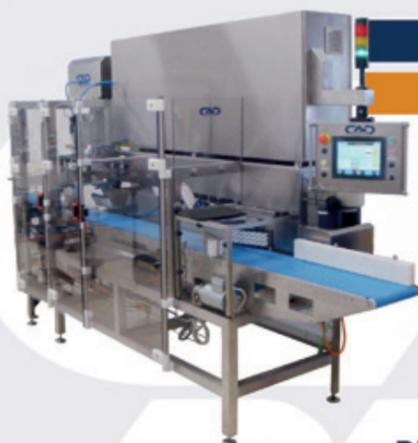
Impianto automatico di porzionatura a peso fisso e taglio a lama ultrasuoni.
