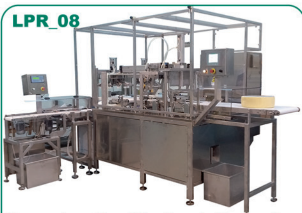
Linea automatica di taglio spicchi peso fisso Exact weight wedges automatic cutter
