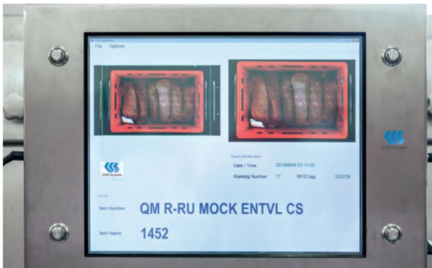
CSB-Eyentifier, per un efficace riconoscimento automatico degli articoli mediante analisi per immagini
