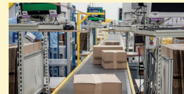
**Controllo qualità:** una volta che i prodotti sono impacchettati, il peso dei pacchetti che scorrono sul nastro trasportatore è rilevato dai sensori. Se il peso del pacco non corrisponde a quello dei singoli prodotti con l'aggiunta della tara, il pacco viene tolto dal circuito per una verifica.
