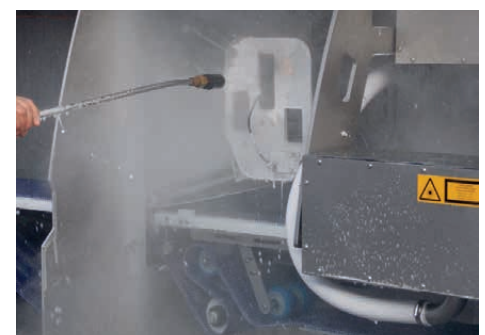
Possibilità di lavare ad alta pressione tutta la macchina, che è completamente impermeabile
