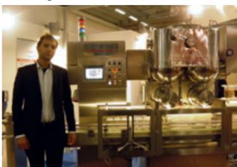
"Siamo specializzati nella progettazione di macchine dosatrici e riempitrici per l'industria alimentare. In fiera presentiamo il restyling di alcuni macchinari, ora dotati di pannello touch screen da 9", una riduzione del 50% dei tempi di cambio formato e l'inserimento di nuove sonde di livello".
