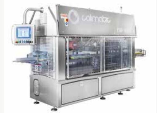
gitori. Rulli di traino film con servomotore, per regolazione svolgimento secondo la tipologia e lo spessore del materiale. Cambio formato rapido. Alto livello di igienicità, con realizzazione di piani inclinati e sistema di smontaggio dei nastri. Possibilità di integrazione con sistemi di carico automatico prodotto, dispositivi in fine linea, sistemi di stampa automatica dei dati variabili. Facilità di gestione. Possibilità di confezionamento in Atm e con processo Skin
