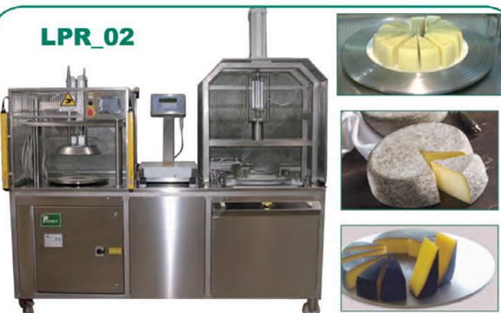
Linea semi-automatica taglio spicchi peso fisso Exact weight wedges semi-automatic cutter
