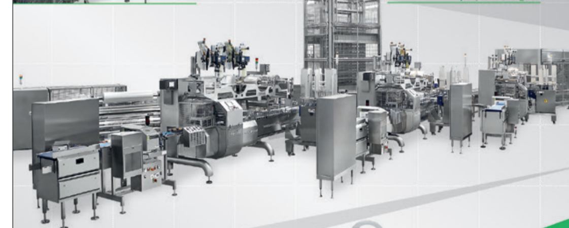
Confezionatrice Flow Pack FP027 versione full inox per il confezionamento dei farmaggi in atmosfera modificata
