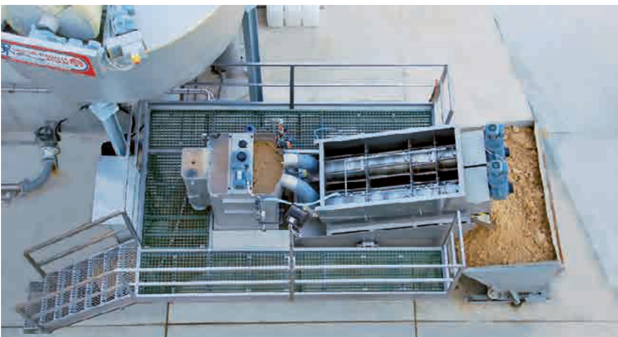
Foto aerea di un gruppo di disidratazione fanghi biologici attrezzato con Coclea Pressa a doppia spirale
